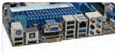
شکل ۵-۱۳- اتصال دهنده‌های روی برد اصلی
