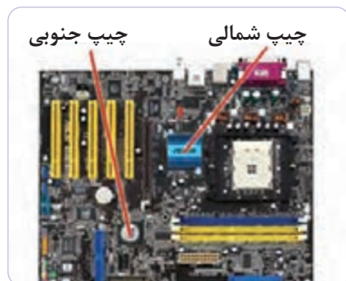
شکل ۵-۱۰- شکل چیپ‌ها در مادربردهای کنونی
