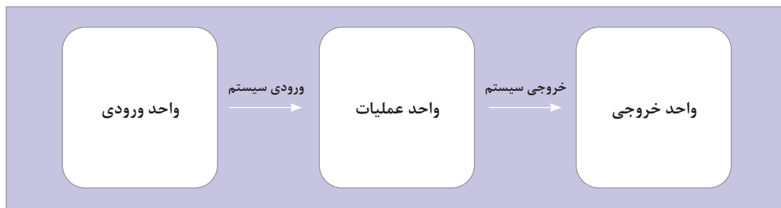
شکل ۱-۱- بخش‌های اصلی یک سیستم
