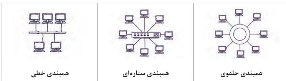
شکل ۸-۴- همبندی رایانه‌های درون یک شبکه محلی
